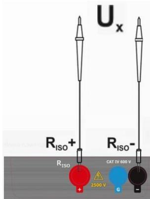
Conectar el medidor a la fuente de tensión.
