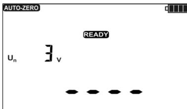
Aparece la inscripción parpadeante **AUTO-ZERO** que confirma la realización de calibración en los cables de medición.
