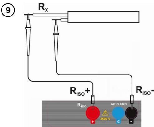
Conectar los cables de medición según la figura.
