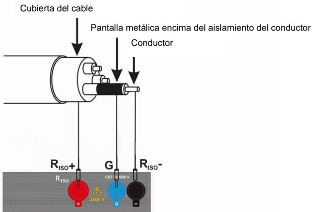
Del mismo modo es el proceso cuando se mide la resistencia de aislamiento entre dos conductores del cable, añadiendo a la pinza **G** otros conductores que no participan en la medición.
